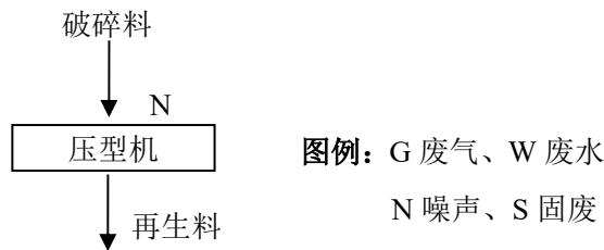
图 3.5-2 项目挤压压型生产工艺流程及排污节点图
