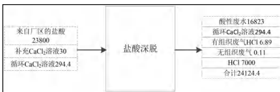
图3.4-3 盐酸深脱物料平衡图（单位：t/a）
