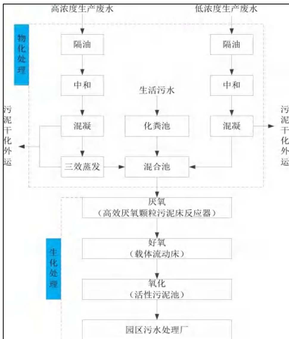
图7.2-1 污水处理站工艺流程图
