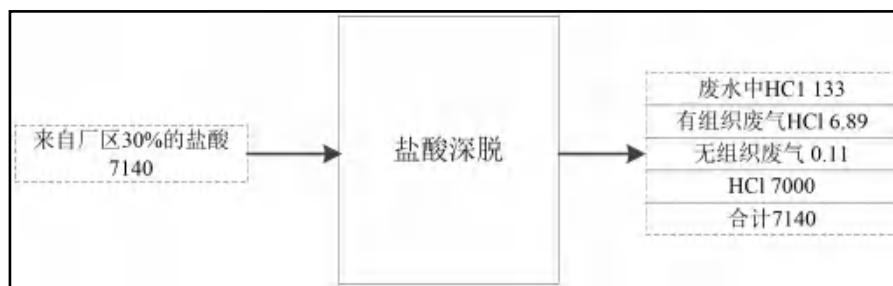
图3.4-4 盐酸深脱HCl平衡图（单位：t/a）
