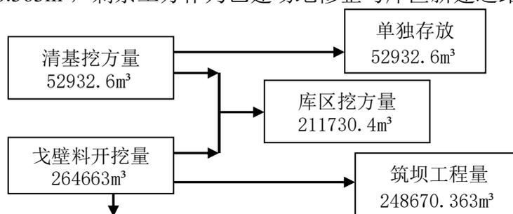
图 3.2-2 土石方平衡图
